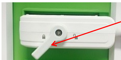
Obrázek 21: Orientace konektoru sondy
