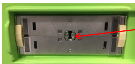
Obrázek 20: Zamykací drážka na slotu konektoru sondy
