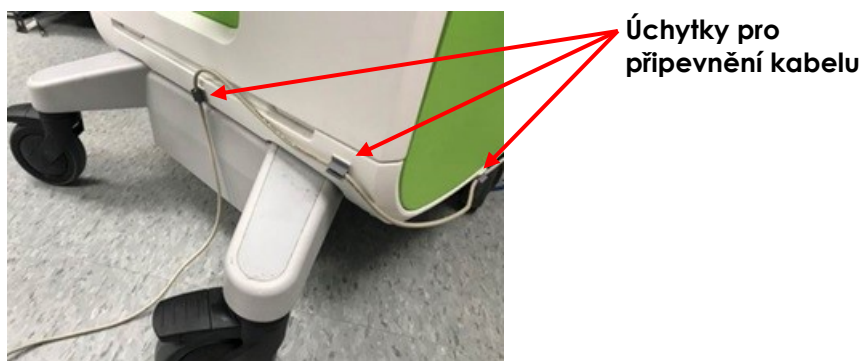
Obrázek 4: Zabezpečení kabelu pedálu
