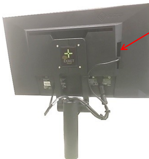
Obrázek 8: Konektory USB na zadní straně monitoru (dostupné u některých konfigurací systému ExactVu)
